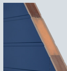
DETAIL ACHTERDEUR Isolerende kern
